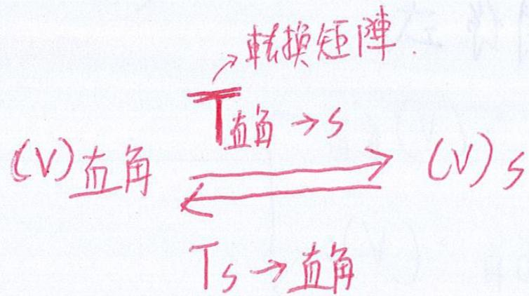
$(V)_S = T_{\text{直角} \rightarrow S} \cdot (V)_{\text{直角}}$  S型
